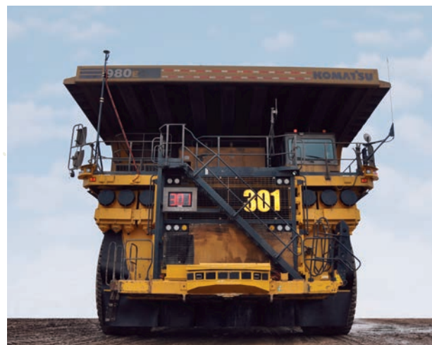
顧客オペレーションの安全性・効率性に寄与する大型無人ダンプトラック
