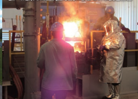
電炉で溶解した金属を取鋼に移している製造工程
