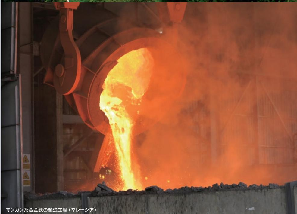
マンガン系合金鉄の製造工程(マレーシア)
