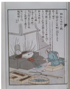
Оригинальный способ рафинирования меди Sumitomo
