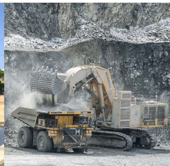
鉱山開発に用いる超大型油圧ショベルとトラック
