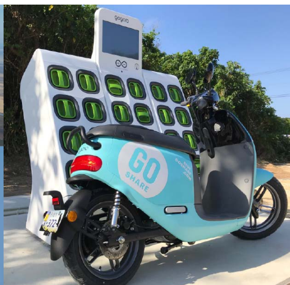
台湾ゴゴロ製スマートスクーターおよび交換式バッテリーステーション
