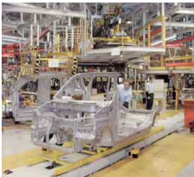
オペルポーランド工場にてボデー生産中の「アギラ」。当社はボデー組み立てライン一式を受注し、2000年1月に納入が完了した。
