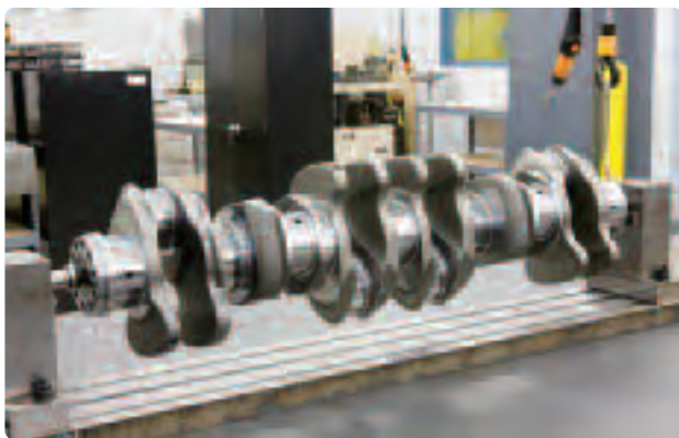
米国機械加工メーカーNorton Manufacturing で製造中のクランクシャフト。同社の買収により、戦略パートナーである住友金属工業とともに母材製造から鍛造、機械加工までの一貫製造体制を確立しました。
