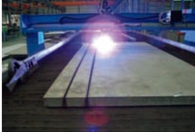
昆山建昌金属科技でのステンレス厚板レーザー切断ライン。中国では建築・インフラ開発や機械製造に用いられるステンレスの需要は増加しており、同社を加工・販売の拠点として新たな需要の発掘・開拓に取り組んでいます。
