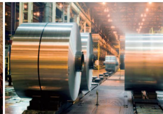
**PHOTO C** 米国のアルミニウム板圧延製造販売会社で製造されるアルミ缶材
