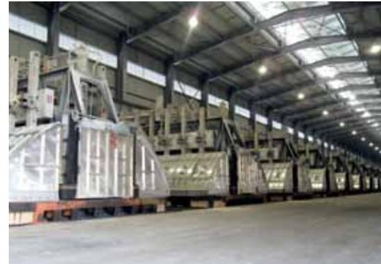
▶ マレーシアのPress Metal社におけるアルミニウム地金を製錬する電解炉
