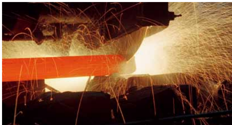
▲ 米国のシームレス鋼管製造会社における鋼管の切断加工の様子
