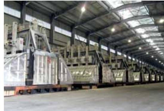
▲ マレーシアのPress Metal社におけるアルミニウム地金を製錬する電解炉
