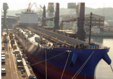
長尺(150m)レールを輸送する専用船
