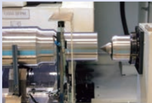
車軸の両端の加工工程 (米国西海岸地域 鉄道用車軸加工事業)
