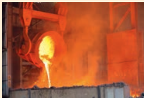
マンガン系合金鉄の製造工程 (マレーシア)
