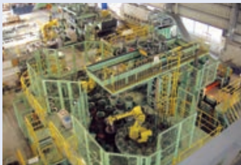
スチールサービスセンター(山口県)の最新全自動刃組み設備
