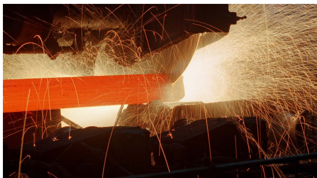
シームレス鋼管製造会社における切断加工の様子
