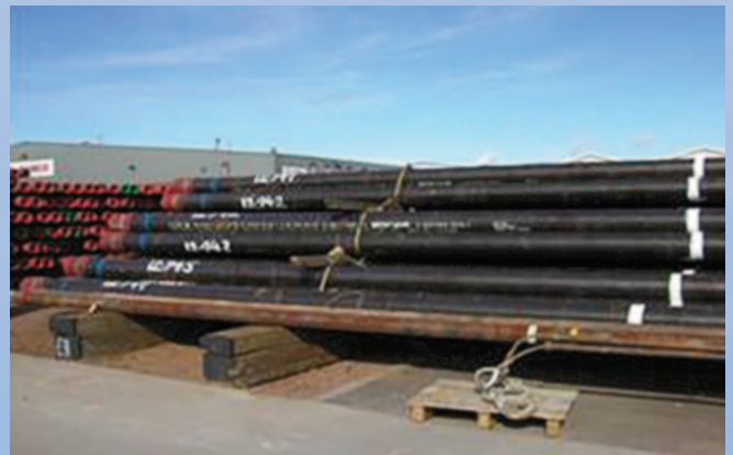
保管中の油井管
