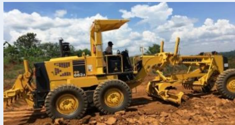
納入した機材で現地オペレーターのトレーニングも行う。 写真は整地に使用されるモーターグレーダー。
