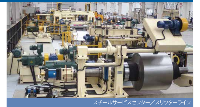
スチールサービスセンター/スリッターライン
