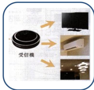
専用のアプリをダウンロードすることで、スマートフォンによるホームオートメーションが実現。スマートフォンの通信圏内であれば、エアコンやテレビ、照明といった登録家電製品のスイッチを遠隔操作でON/OFFできます。
